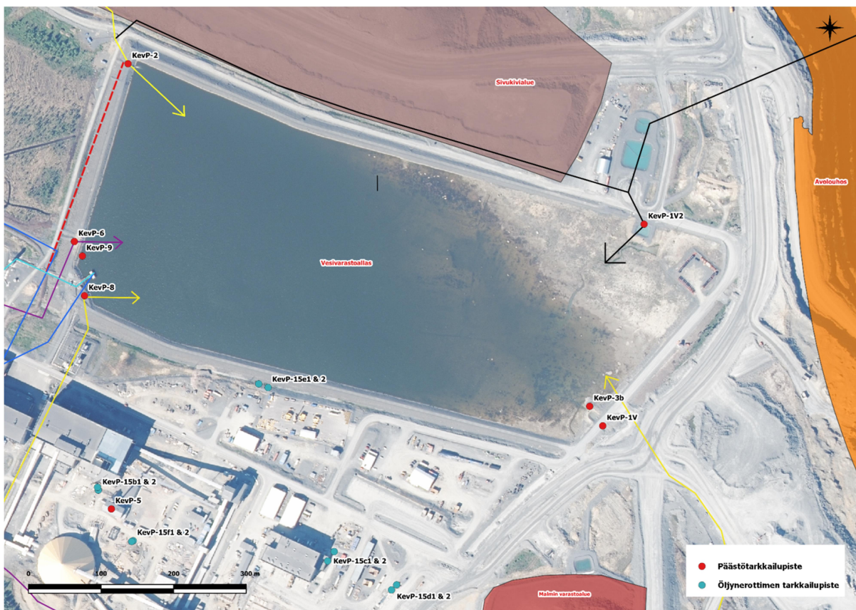
Kuva 4-1. Kevitsan vesivarastoaltaalle tulevien vesien näytteenottopisteet. Avolouhoksen vedet saapuvat altaalle koilliskulmasta, kaakkoiskulmassa ovat pisteet KevP-1V ja KevP-3b, sekä pisteet KevP-8 toinen purkupiste toinen altaan lounaskulmassa kuten myös hulevesien purku KevP-6. Altaan luoteiskulmaan saapuvat sivukivialueen vedet pisteen KevP-2 kautta.
