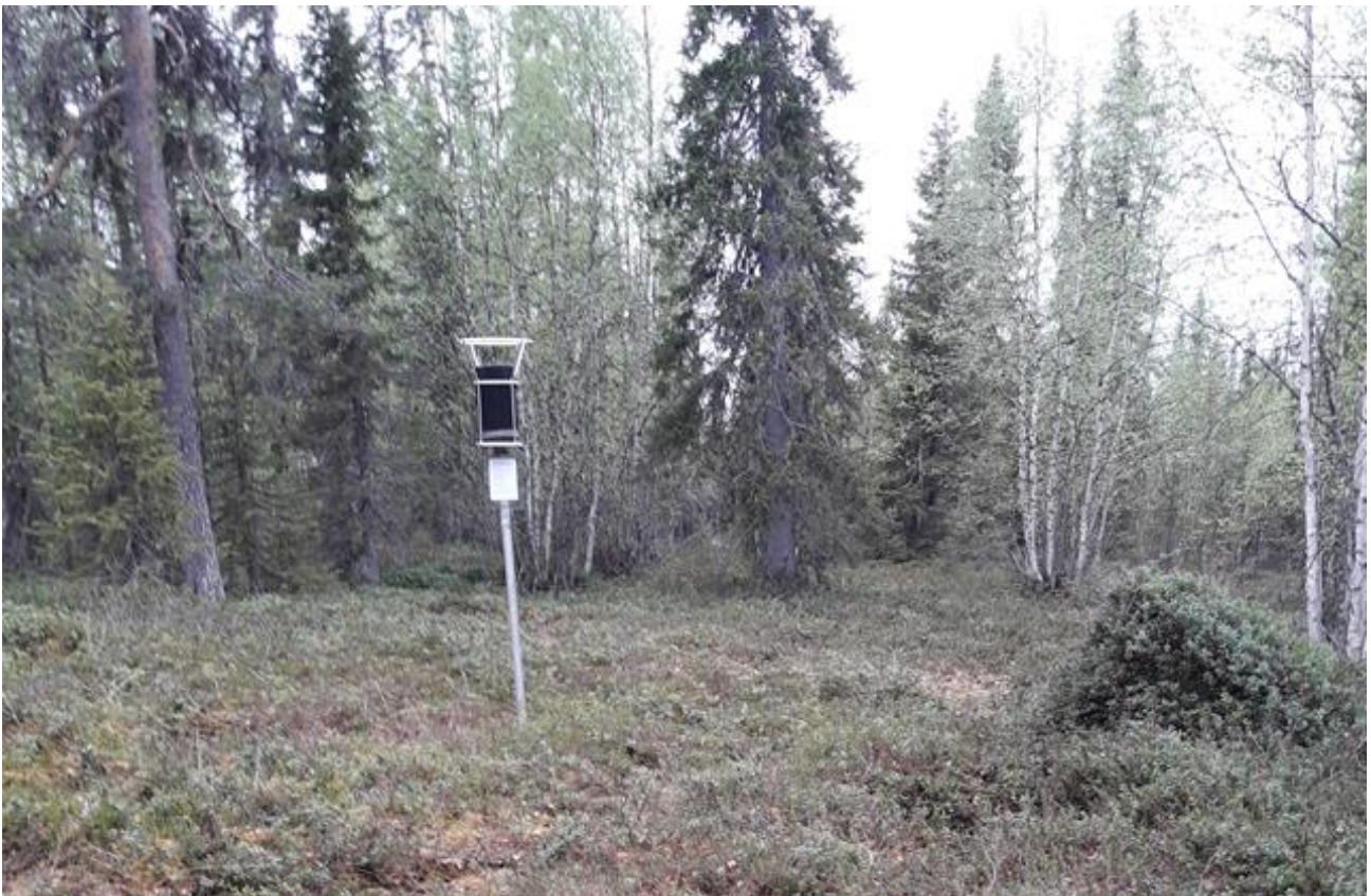
Kuva 3 Esimerkkikuva laskeumakeräimestä maastoon sijoitettuna.
