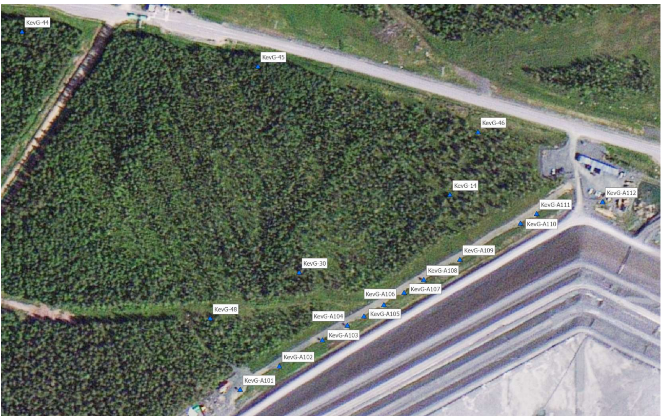
Kuva 6-4. Suojaumpauskaivojen (KevG-A ***) sekä pohjaveden tarkkailuputkien sijainnit kartalla.
