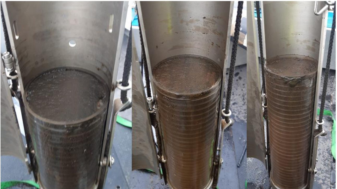
Kuva 3-3. Kuvassa sedimentinäytteet vuodelta 2022 (vasemmalla KevSED1 4 cm, keskellä KevSED2 4 cm ja oikealla KevSED3 4 cm).
