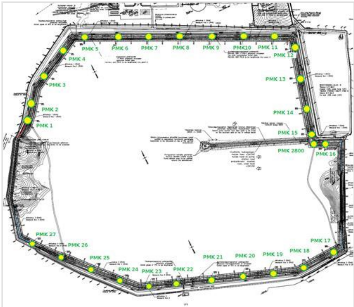
Kuva 7 : TSF A Korotusvaiheen 4 harjalle asennettujen PMK-pisteiden sijainnit.
