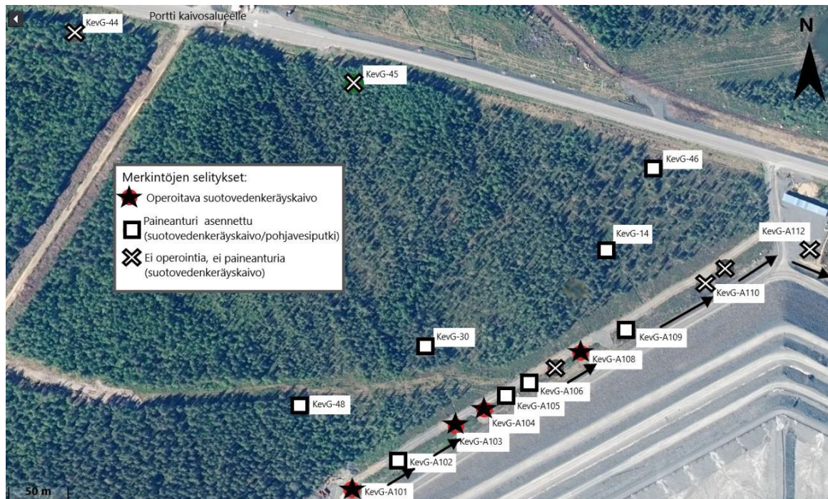
Kuva 1. Suojapumppauksen järjestely KevG- 14, -30, -44, -46 ja -48 ovat pohjavesi-putkia ja KevG-A101–A112 ovat suotovedenpumppauskaivoja. Kaivot, joissa on ollut jatkuva pumppaus, on merkitty tähdellä.
