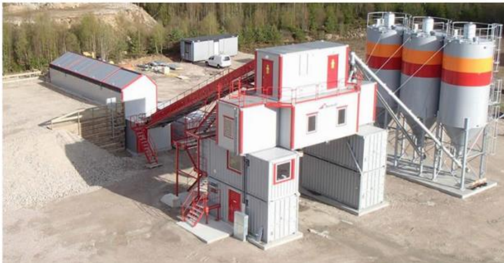
Figur 66. Exempel på anläggning för lagring och blandning av paste (Källa: Paterson & Cooke, 2022)
