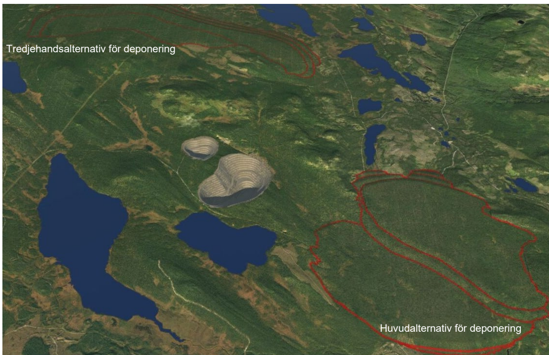
Figur 21. Alternativa lokaliseringar 2023. I rött visas layout för huvudalternativ för deponering och för tredjehandsalternativ. Andrahandsalternativet innebär samma lokalisering som huvudalternativet men med ett större markanspråk. Det är ej slutlig layout för huvudalternativ som visas i figuren.
