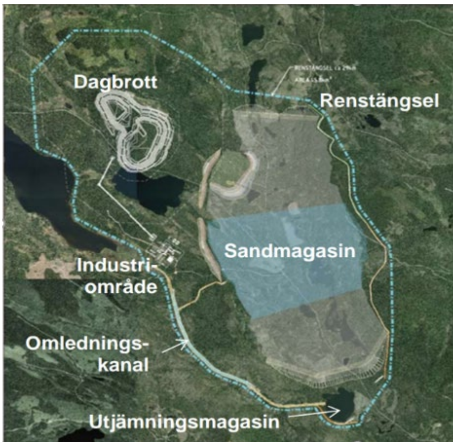
Figur 16. Slurrydeponering i anslutning till dagbrott och industriområde från 2013.
